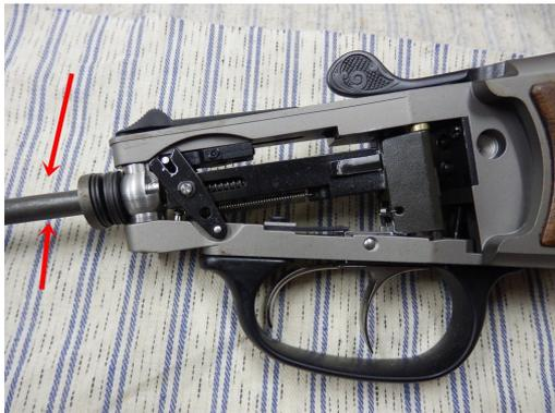
die Gewindestange müssen Sie herausdrehen. ( Am besten die Stange in einen Schraubstock einspannen und rausdrehen )
